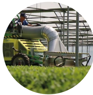
Aspirazione dei residui Suction of cuttings residues
